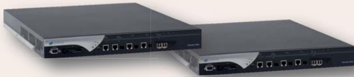
Die zentrale Intelligenz der hochverfügbaren Speicherlösung stellen die beiden gespiegelten SANRAD 3400 Switches dar
