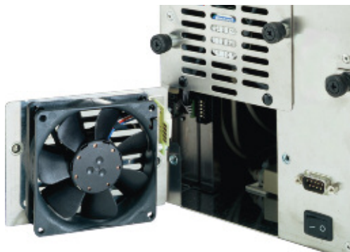
Die Lüfter lassen sich bei Bedarf im laufenden Betrieb austauschen.
